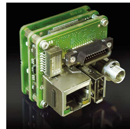
Die Kamera VRmDC-12/BW ist mit etwa 50 g Gewicht besonders leicht und kompakt
