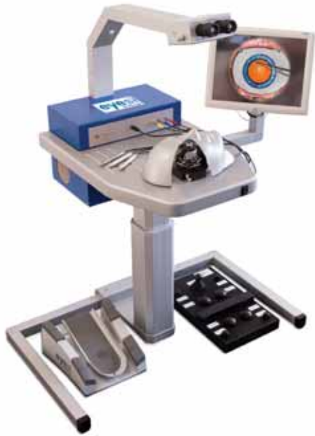
Bilder 2a und 2b: Im Patienten-Modellkopf des Operationsimulators wird optisches Echtzeit-Tracking auf kleinstem Bauraum umgesetzt
